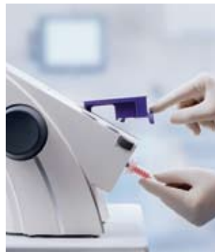
Prosta wymiana końcówek mieszających – bez otwierania pokrywy.
